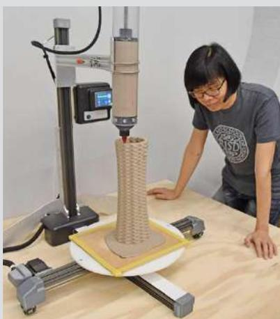
華梵大學引進 3D 陶瓷列印機。採用 3D 陶瓷列印技術製作陶藝作品，讓同學們將傳統陶瓷製作技術延伸至 3D 列印素材應用，使創作擁有更多的想像空間。
